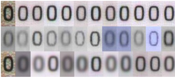
Рис. 4 Примеры изображений символа «0», полученных: Верхняя строка: со сканера, средняя: с веб-камеры, нижняя: путем синтеза.
